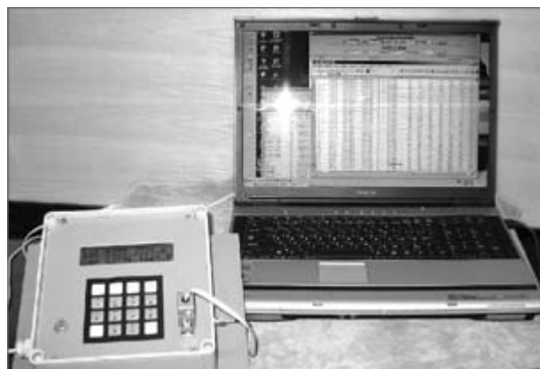
Рис. 2. Устройство регистрации и координатной привязки, подключенное к персональному компьютером
