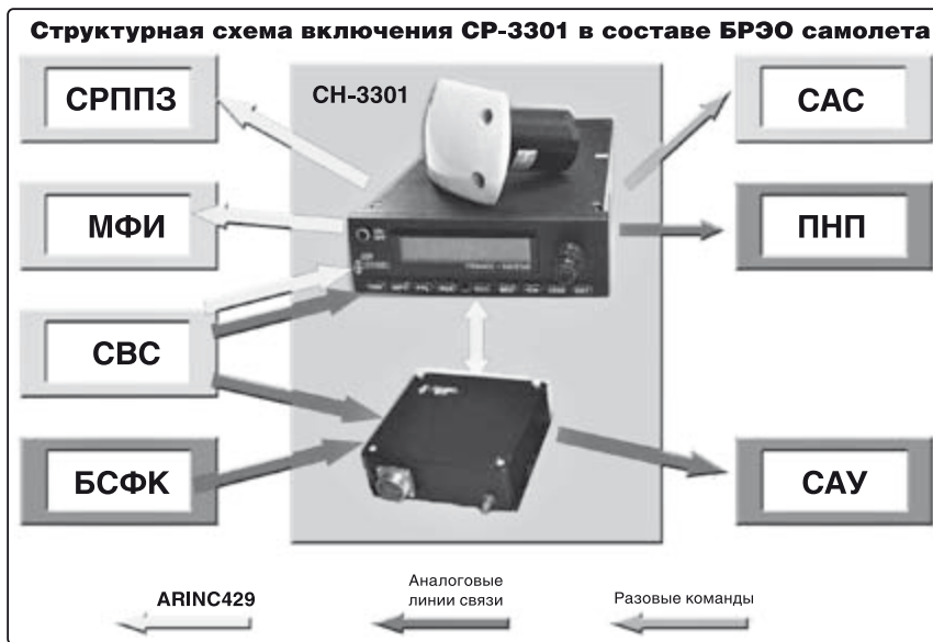
Рис.5. Структурная схема включения аппаратуры СН-3301 в состав БРЭО
