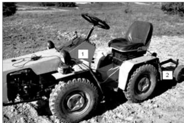
Рис. 1. Экспериментальный образец мобильного анализатора почвы, установленной на минитракторе: 1 – устройство регистрации и координатной привязки; 2 – многоканальная сенсорная система
